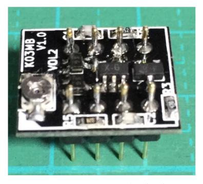
3)KO3MA基板を連結ソケットのピンギリギリになるように差し込んで、表面でピンをはんだ付けします。
