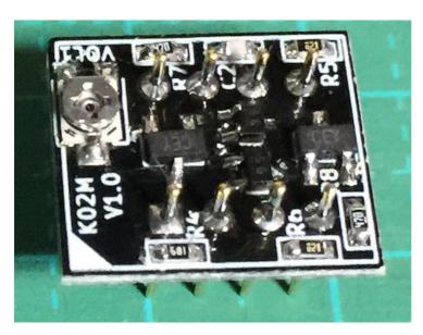
3)連結ソケットの飛び出したピンをニッパーでカットして完成です。
